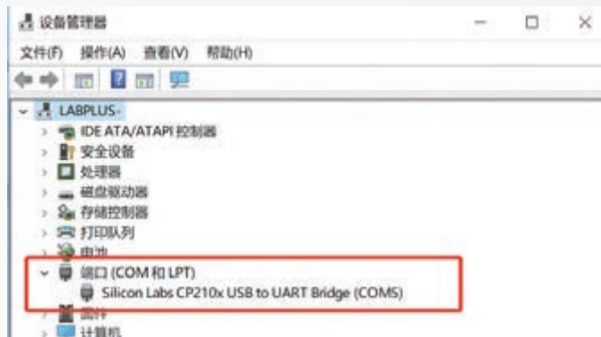
图1.1.9 在计算机设备管理器中查看端口号
