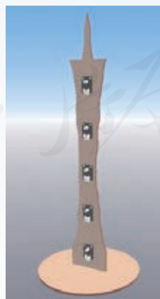
(b) 二极管模块安装示意
