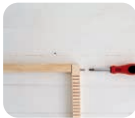
② 与带刻度的木棒相对而放，然后用螺丝固定综框，不需要固定安装。
