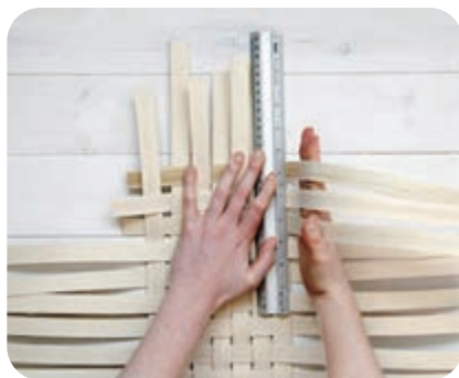
④ 再次用钢尺，弯折三根竹条。
