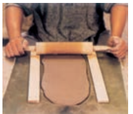
1. 滚压泥板，厚度均匀。
