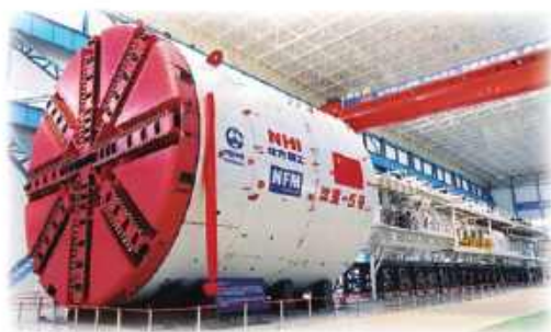
开凿隧道的盾构机
