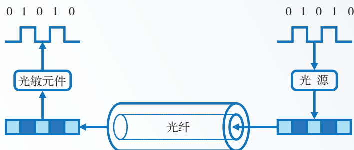
图 1.2.6 光纤通信原理示意图
