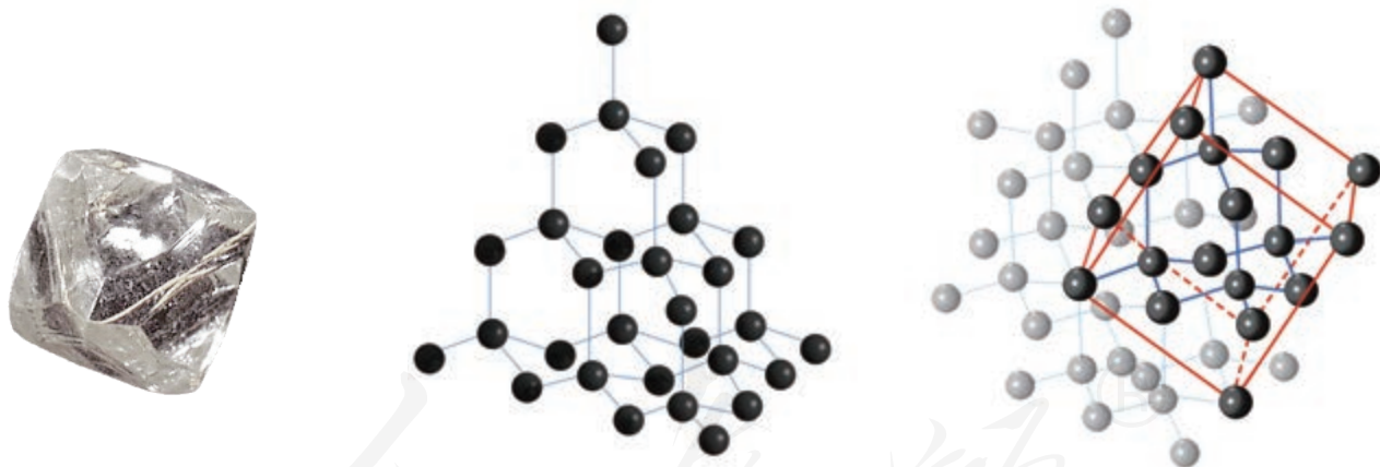
图3-21 金刚石的多面体外形、晶体结构和晶胞示意图
