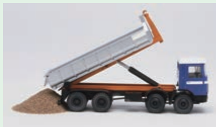
图1-16 自动翻转卸料装置设计
