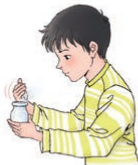
图1-5 闻气体时的正确操作
