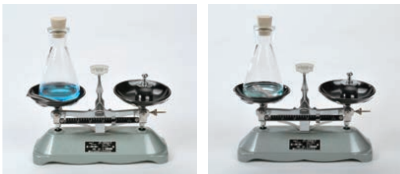
图5-3 铁钉与硫酸铜溶液反应前后质量的测定
