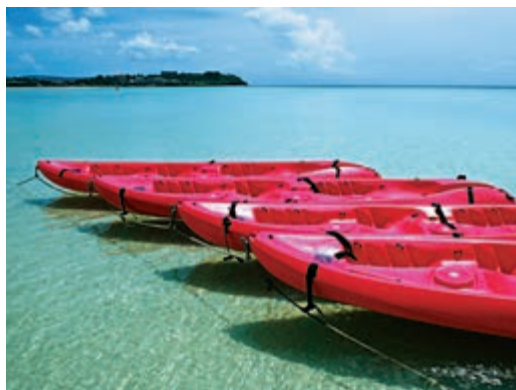
图9 用玻璃钢制成的船体
