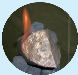
图7-32 陆地冻土区可燃冰实物样品
