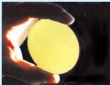
图6-7 透明的金刚石薄膜
