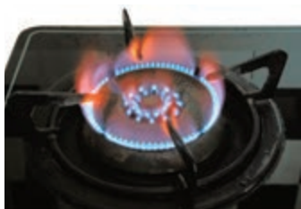
图7-31 燃气燃烧出现黄色火焰
