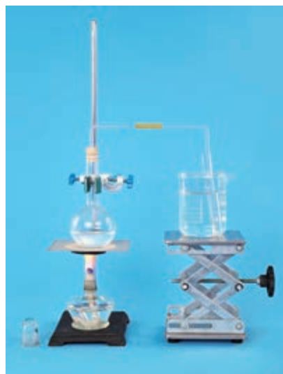
图4-21 制取蒸馏水的简易装置
