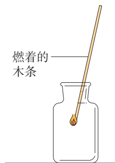
图1-17 用燃着的小木条检验气体
