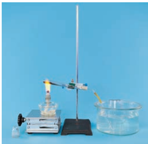
图2-14 加热高锰酸钾制取氧气
