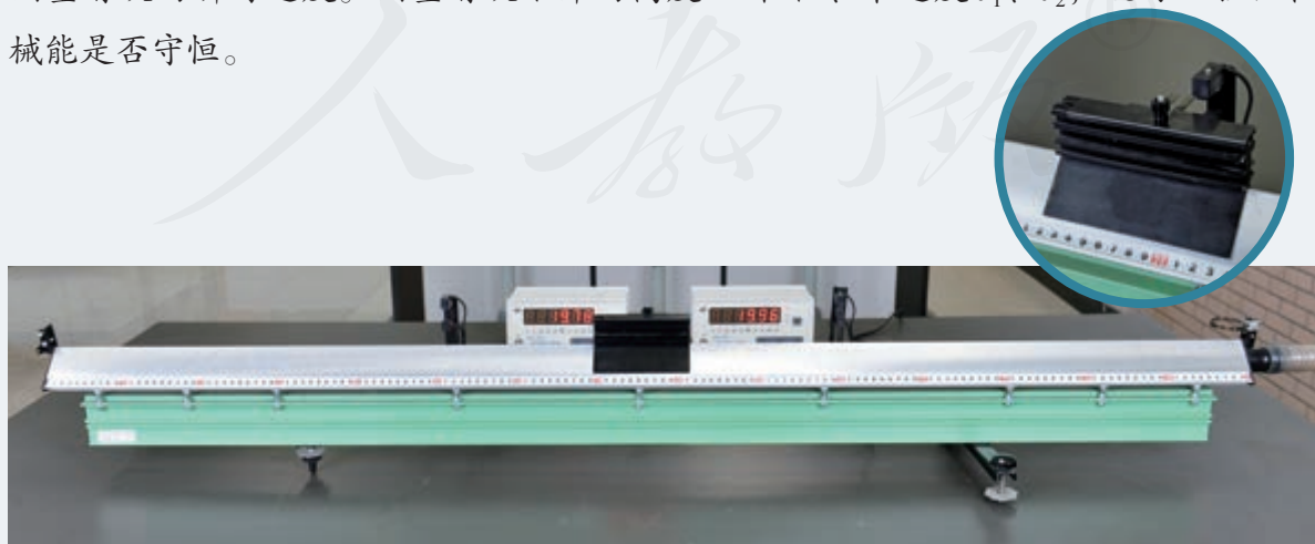
图 8.5-4 研究沿斜面下滑物体机械能的实验装置
