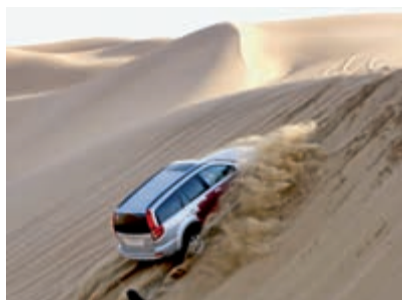
图 8.1-4 汽车上坡时必须使用低速挡
