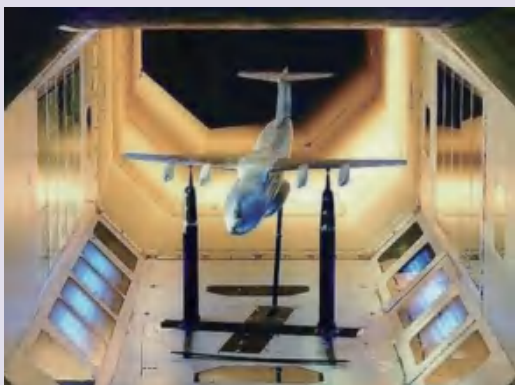
图4-17 风洞试验中的飞机模型
