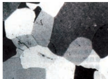
图2.4-7 金相显微镜下的铝—锂—锰合金
