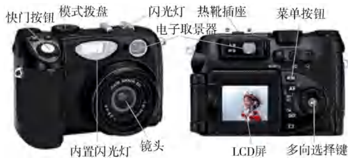
数码照相机结构图
