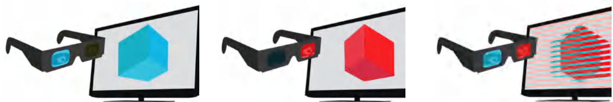
| 通过滤色片过滤红蓝双色的光线，使双眼获得不同的视觉信息图示
